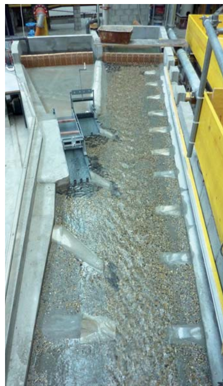
Bild 1. Physikalisches Modell der Einleitung des geplanten Beruhigungsbeckens der Kraftwerke Oberhasli AG in die Hasliaare. Oben links ist ein Teil des Beruhigungsbeckens und oben rechts das Ende der Restwasserstrecke zu sehen. Die Fliessrichtung ist auf diesem Bild von oben nach unten.
